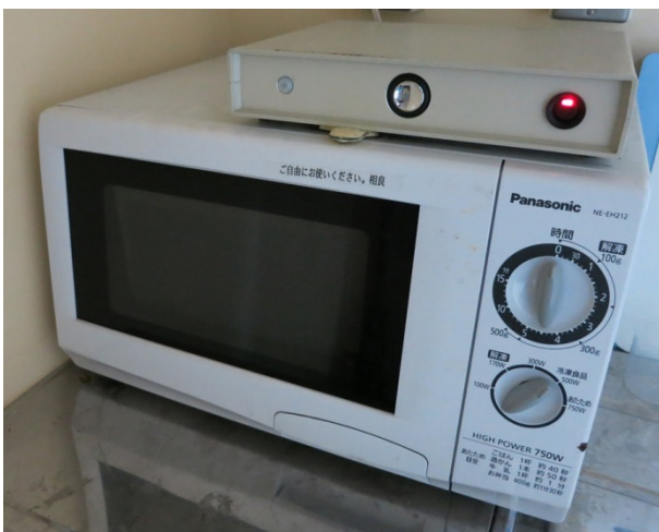
図6 電子レンジの上に乘せた電子レンジモニタ
