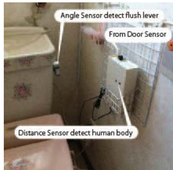
図12 トイレフラッシュ促し装置の設置状態
