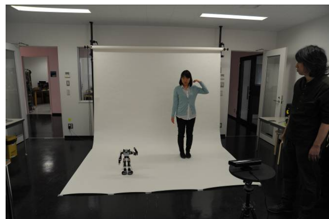
図 17) 図 18) 上は KINECT が認識した人間の骨格。骨と関節をワイヤーフレームで表示。下は、実際に人間の動作を読み取った KINECT のデータを転送、ロボットに再生させている。
