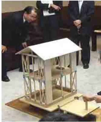
図 23. 耐震実験装置「ぶるる」(木工ワーキンググループ) (撮影:静岡県健康福祉部)
