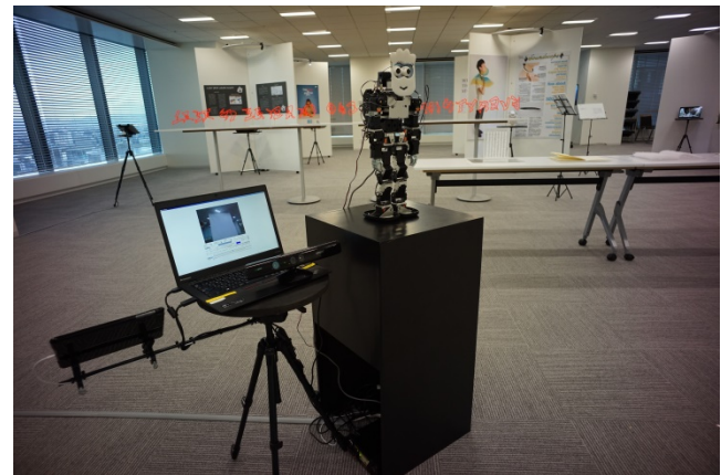
図 20 Do it together。KINECT センサーにより人間の動作を読み取り、鏡像反転してこれを再生、顔と眼が対象を追跡する。
