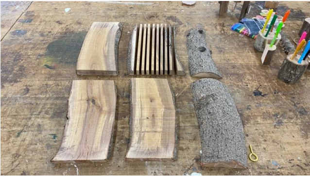
写真4 伐採材の挽きおよび反りの調査事例。ヤマモモ。活用できる木材および燃焼材に使用できる部材に分類する。2022年8月。筆者撮影。
