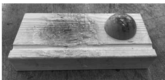
角材に半球状の木材を貼り、トリマーで溝を掘ったものを作成した。
