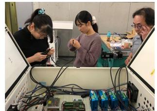
図15 配電盤を製作する様子
