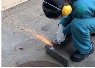
図5 グラインダーによる切削の様子
