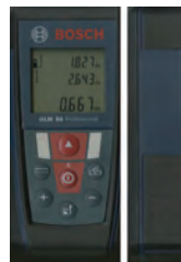
図4) BOSCH GML-50 レーザー測距器。性能は測定可能範囲：0.05 ~ 50m。
