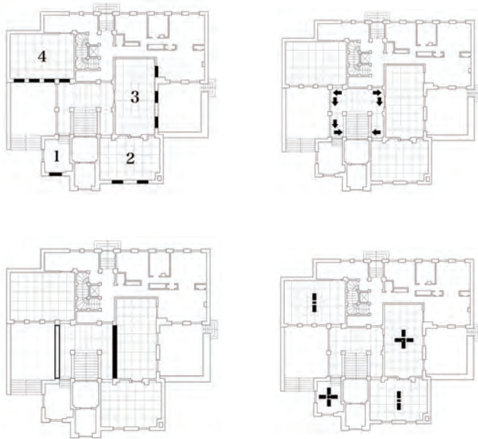
図 29) ストンボロー邸の中央ホールを中心とする4つの部屋の関係を示す例。左より、部屋の開口部数の最大値の左回りの数列(1・2・3・4)、中央ホールドアハンドルの取付方法(例:正面左側のドアは左手用ハンドル、右側のドアには右手用ハンドルが組みつけられているが、反対側玄関側のドアには正面とは逆の内向きの組み付け方法が行われている)、中央ホールの左側は透明がガラス壁面とガラスドアで構成され、右側は不透明な壁と鉄製の不透明なドアで構成されている、4つの部屋の軸線の数(左周りに2軸・1軸・2軸・1軸)の変化(小山作成、Akira Koyama)。
