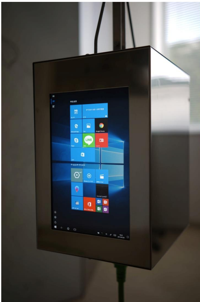
図 8：映像再生装置は、タブレット PC を用いている。
