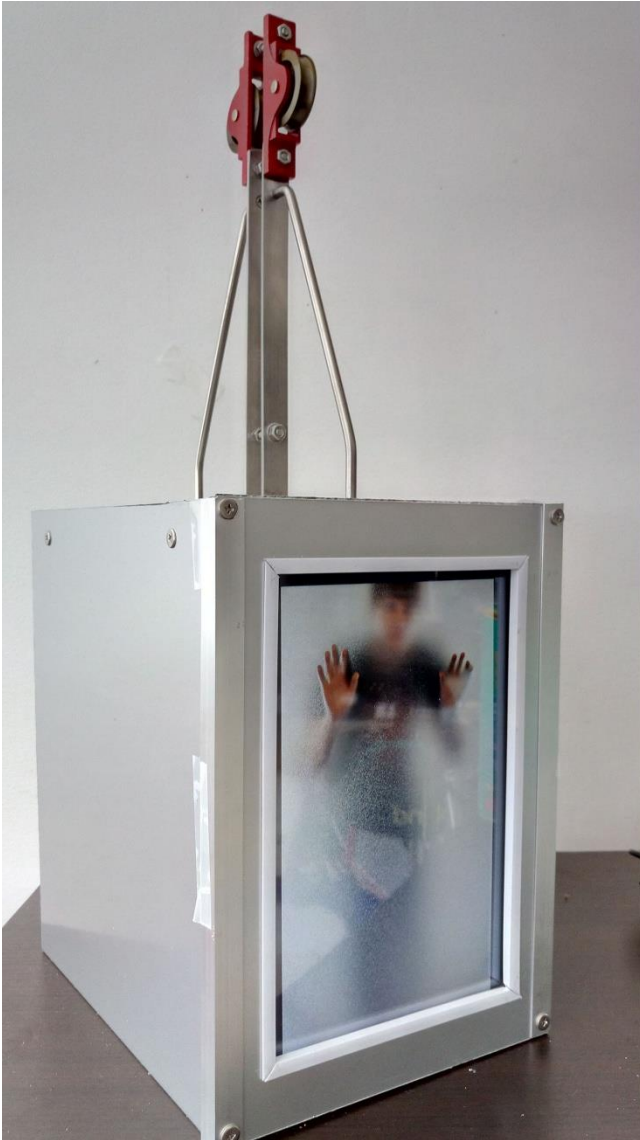
図6：アルミ複合板を用いた試作品
