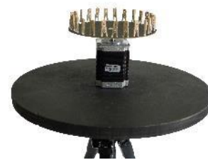
図3) 回転盤・ステッピングモーター・制御基盤の関係を示す図。制御は軽い円盤の場合、Arduinoという簡易な制御基盤でも行うことができる。概念的には矩形波のように瞬時に加速し瞬時に停止するが、現実の世界では質量が伴うため、制御プログラムの開発には度重なる試行が必要とされる。
