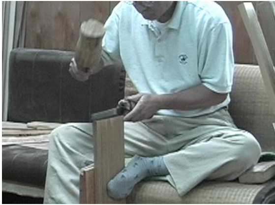
図 18 へぎ板 8 枚取りの角材からへぎ板を作る
