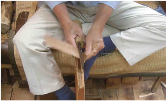
図 21 亀甲網代用へぎ板製作
