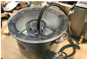
図5 減圧装置および装置の機構略図
