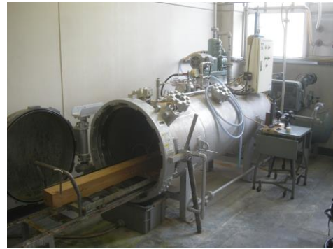
図3 あいち産業科学技術総合センター減圧加圧装置
