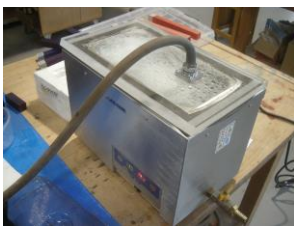
図6 超音波照射機能付き減圧装置および装置の機構略図
