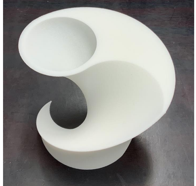
図10：RhinoCeros 7 + Python で作成した太極お猪口。3Dプリンターで出力している(出力はDMMに委託)。素材は「ナイロン ナチュラル」を用いた。
