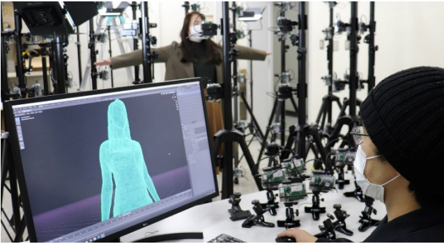
図3 Raspberry Pi を 120 台用いた三次元スキャナ
