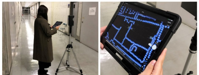
図6 Matterport Pro2 と iPad システムによる撮影風景
