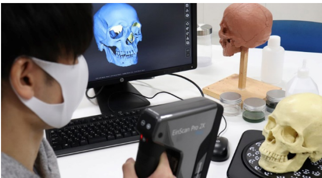
図5 EinScan Pro2X によるスキャン実験
