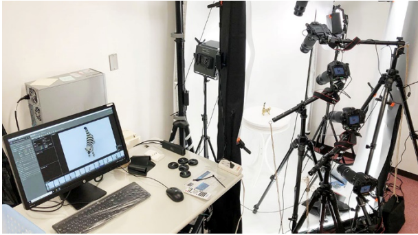
図6 一眼レフとターンテーブルによる撮影システム
