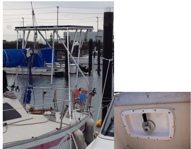
図8：完成したソーラー架台とコントロールパネル
